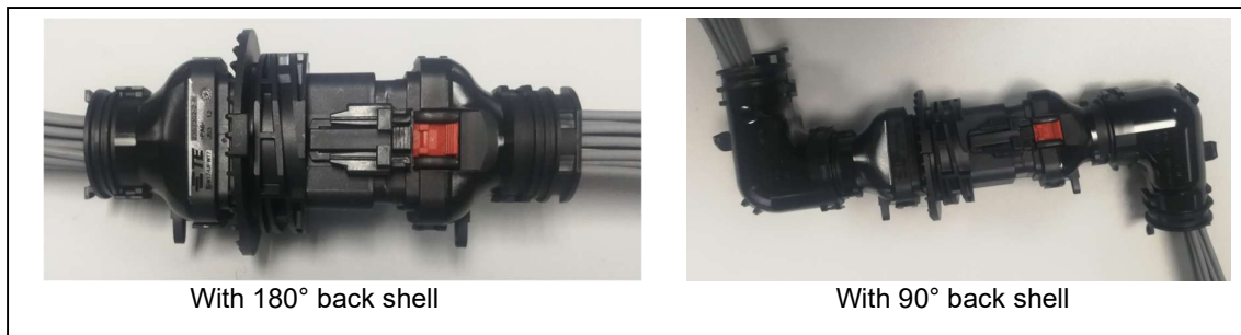
Figure 2.6.1.3 Installation figure 图 2.6.1.3 安装效果示意图
