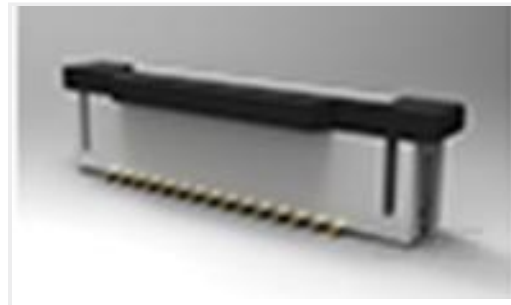
TE Part # 1-1734248-1 1.0 FPC, ZIF V/T, SMT, 11P
